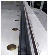
CVD CFC 装置改善清洁气流，减少 NF 3 用量
