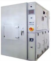
Cvd Scrubber 处理尾气装置，NF 3 去除率 99% 以上
